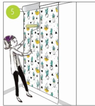
5. Χρησιμοποιήστε το ρολό λείανσης και λειάνετε τα σημεία που τοποθετείτε. Αν σε κάποια σημεία μείνει αέρας, αφαιρέστε τον πατώντας με το ρολό λείανσης κάνοντας κινήσεις αριστερά - δεξιά ή ξεκολλήστε λίγο το φύλλο και επανατοποθετήστε το.
